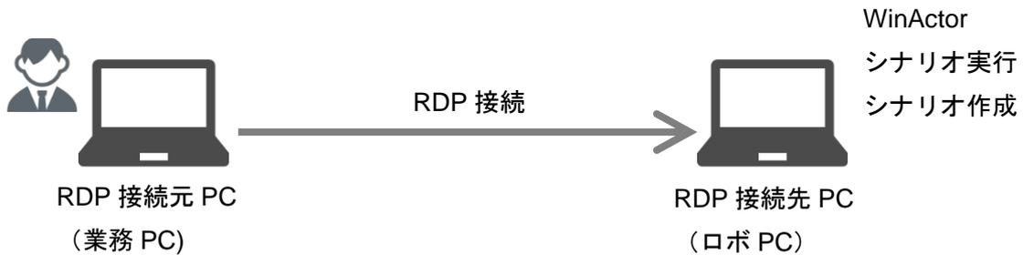
図 1 リモートデスクトップ接続構成図
